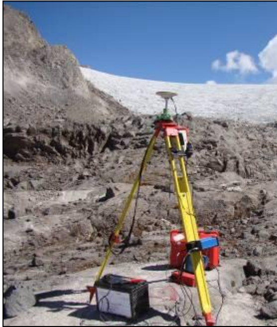
Figura 36. GPS Leica utilizado para el levantamiento topográfico.
