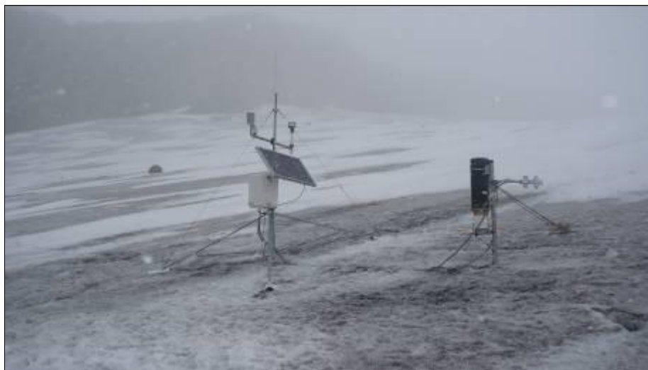
Figura 7. Estación Meteorológica Móvil de Altitud EMMA (4760m.). Fotografía Edgard Leonardo Real
