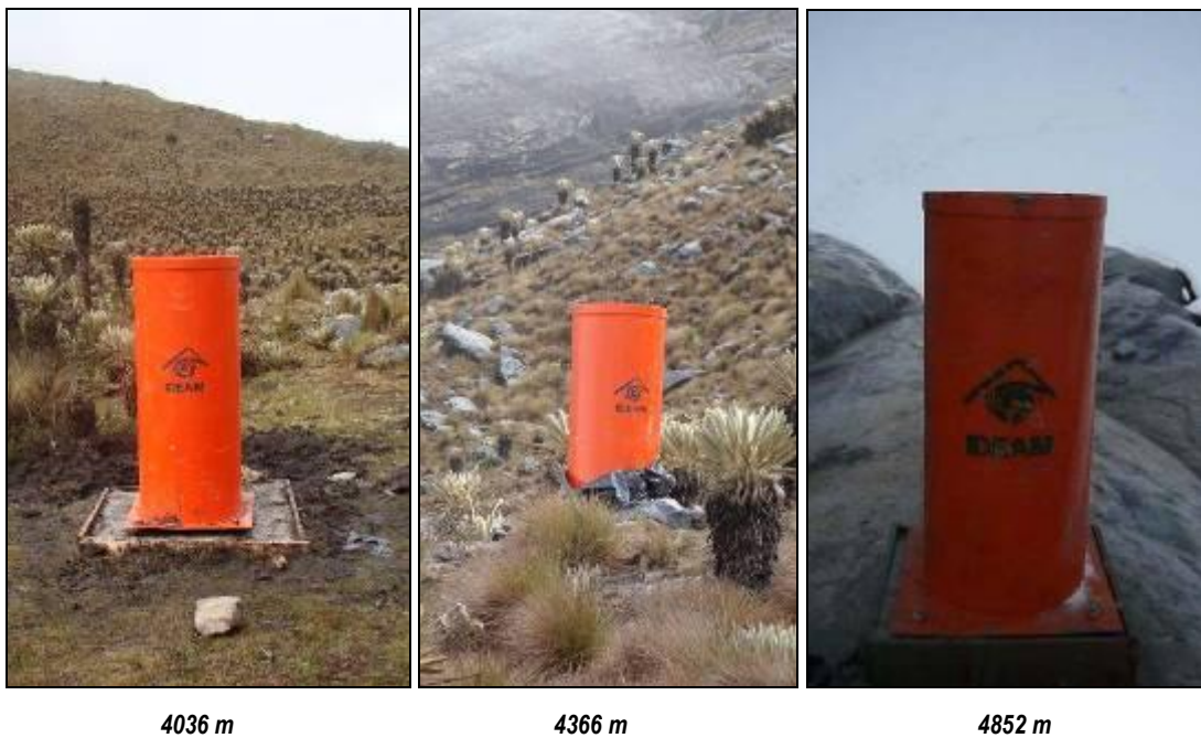
Figura 64. Fotografías de los pluviómetros totalizadores ubicados en la cuenca alta del río Playitas sierra nevada de El Cocuy.
