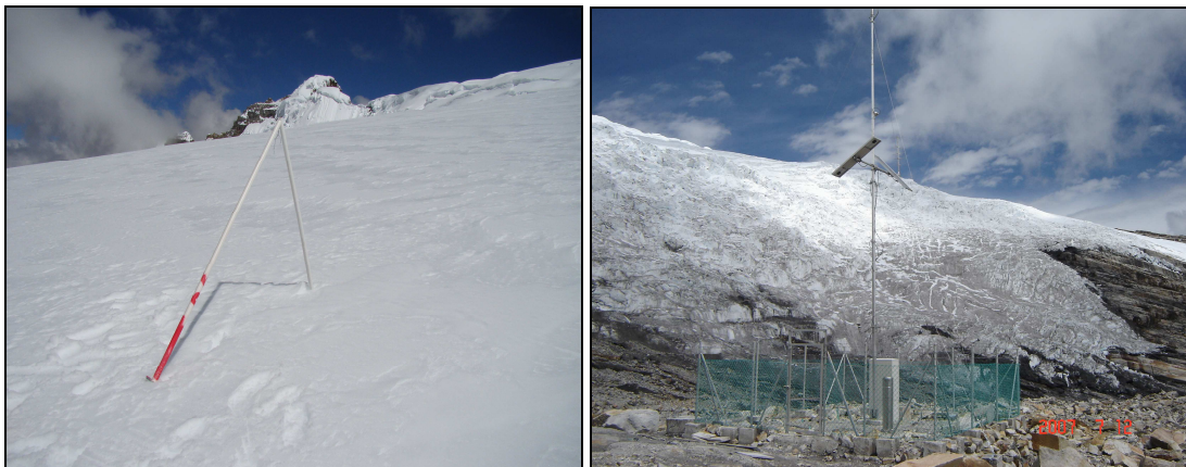
Figura 5. Izquierda fotografía de la baliza N° 4 instalada en el glaciar Ritacuba blanco. Derecha fotografía de la estación automática satelital instalada en el borde del glaciar Ritacuba Negro.
